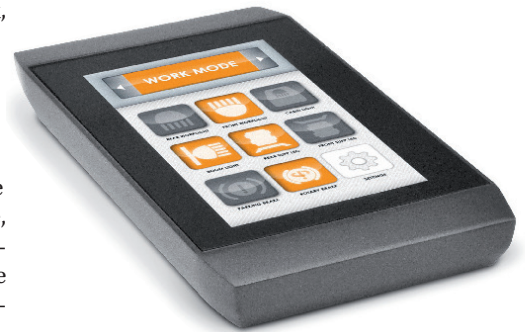
Das neue Konzept für Bedienpanels beinhaltet einen 4“3 PCAP-Touchscreen, mit einem Smartphone-ähnlichen Benutzererlebnis
